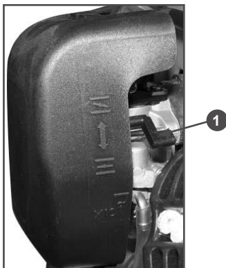
Рис. 9 Расположение воздушной заслонки
