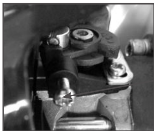
Рис. 16 Винт настройки оборотов холостого хода
